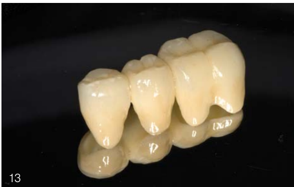
фиг. 13 Завършеният мост от цирконий и керамика.
