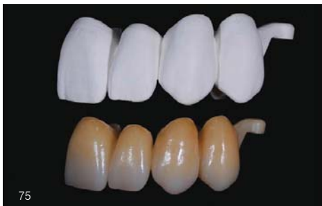
сн. 75 Обработка на циркония в зелена фаза и след синтерование.
